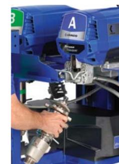
3. Retire la manguera y deslice la bomba hacia fuera
